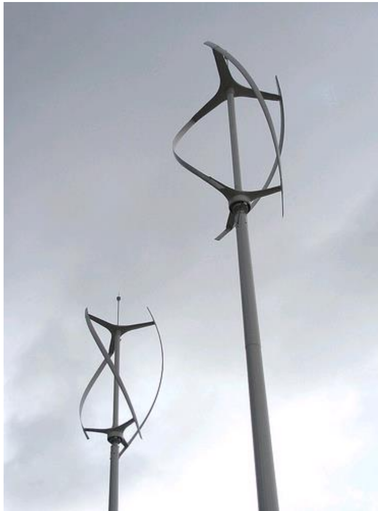
Aerogenerador de eje vertical
